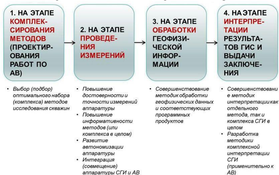
Рисунок 3. Направления совершенствования геофизического сопровождения
