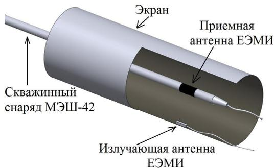
**Рис. 3.** Лабораторная экранирующая установка
