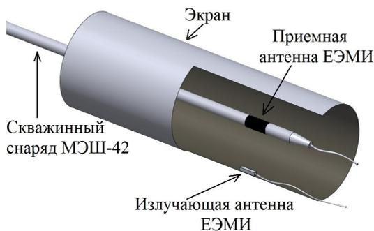
**Рис. 3.** Лабораторная экранирующая установка
