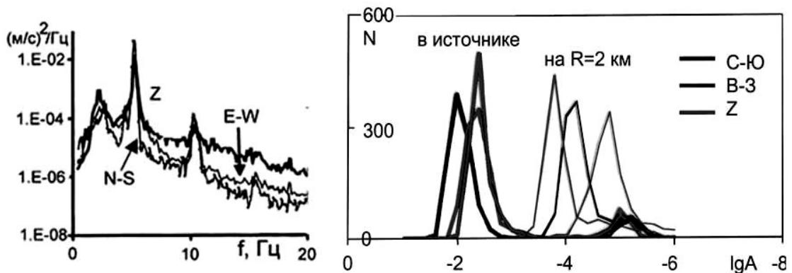
Рисунок 1 – Типичные спектры мощности микросейм вблизи источника и распределения значений амплитуд для двух точек наблюдения вблизи источника и на расстоянии 2 км
