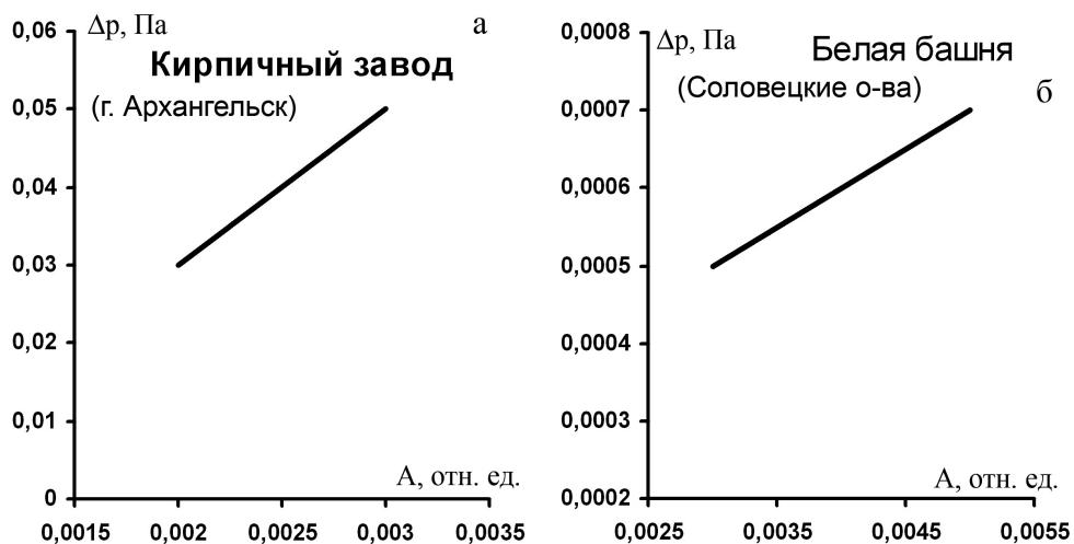
Рисунок 2 – Калибровочные кривые для разных типов инженерных сооружений
