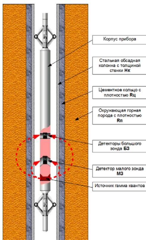
**Рис. 3.6.** Геометрия скважинных измерений аппаратурой типа СГДТ-НВ.
